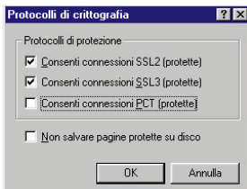
Figura 5 - Per configurare i protocolli di crittografia di Internet Explorer si deve scegliere il comando Opzioni del menu Visualizza, fare clic sulla scheda Avanzate e infine premere il pulsante Impostazioni della crittografia.
