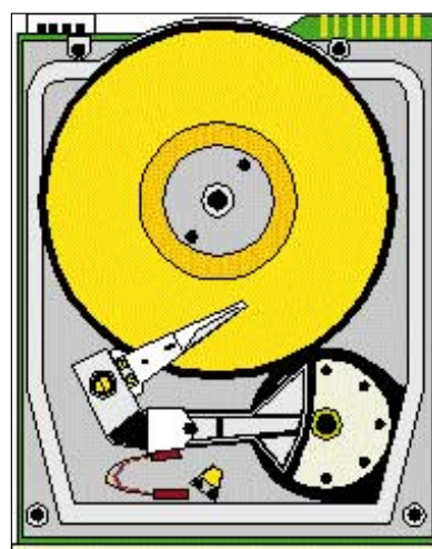
L'immagine mostra come è fatto un disco rigido. Nella parte superiore, il disco sul quale vengono registrati e letti i dati. In basso invece si vedono la testina di lettura/scrittura e il motore che ne permette il corretto posizionamento sulla superficie del disco.
