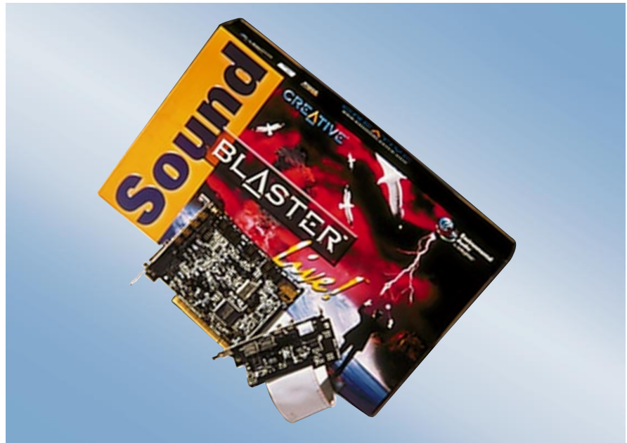
Soundblaster Live von Creative Labs: Die Karte hat gute Audio-Eigenschaften, aber als digitale Schnittstelle zum externen Wandler taugt sie nur bedingt (Tip 4)
