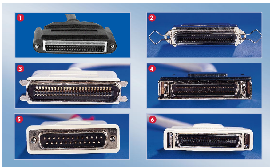
Unterschiedliche SCSI-Stecker: Da kommt es schon mal vor, daß Scanner und SCSI-Host-Adapter verschiedene Anschlüsse haben (Frage 10)
