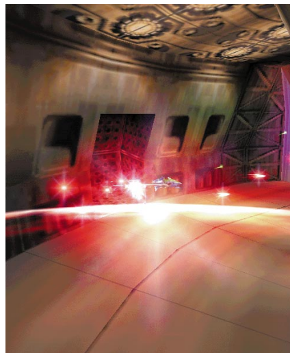
Mit bilinearer Filterung: Das Bild ist unschärfer, aber die Blöcke sind weg
