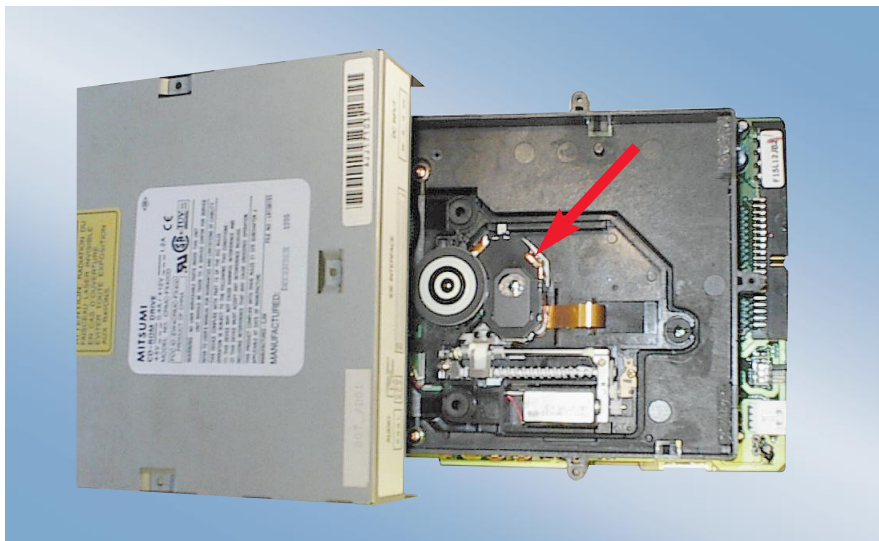
Am Ziel: Wenn Sie unsere Anweisung zum Öffnen des Mitsumi FX400 befolgt haben, sehen Sie die Linse (siehe Pfeil) vor sich (→ Kasten „Linsenreinigung“)
