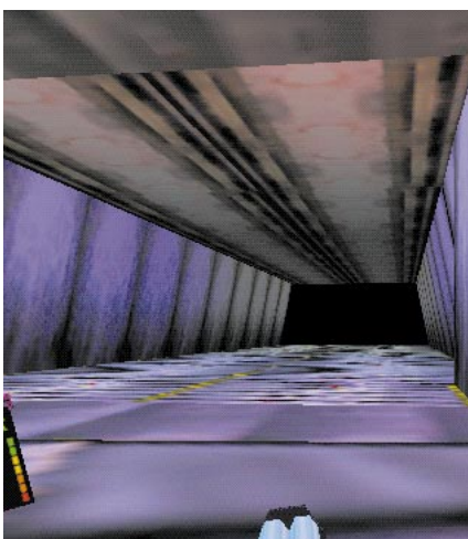
Ohne Mip-Mapping: Die Struktur des Fußbodens hat irritierende Schlieren
