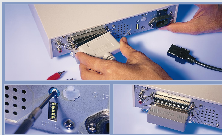
Externer Brenner: Er wird mit dem Kabel angeschlossen, das der Packung beiliegt, wobei der große Stecker an das Gerät kommt
