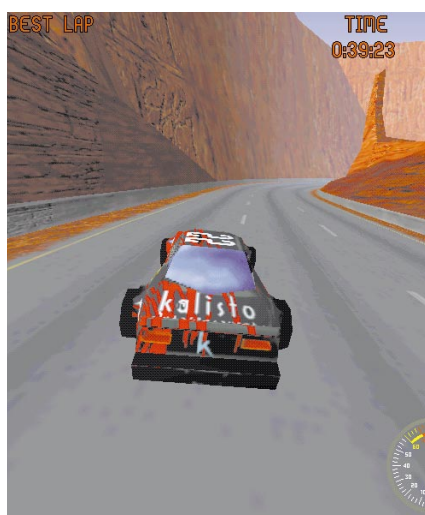
Mit Environment-Mapping: Der Himmel spiegelt sich in der Heckscheibe wider
