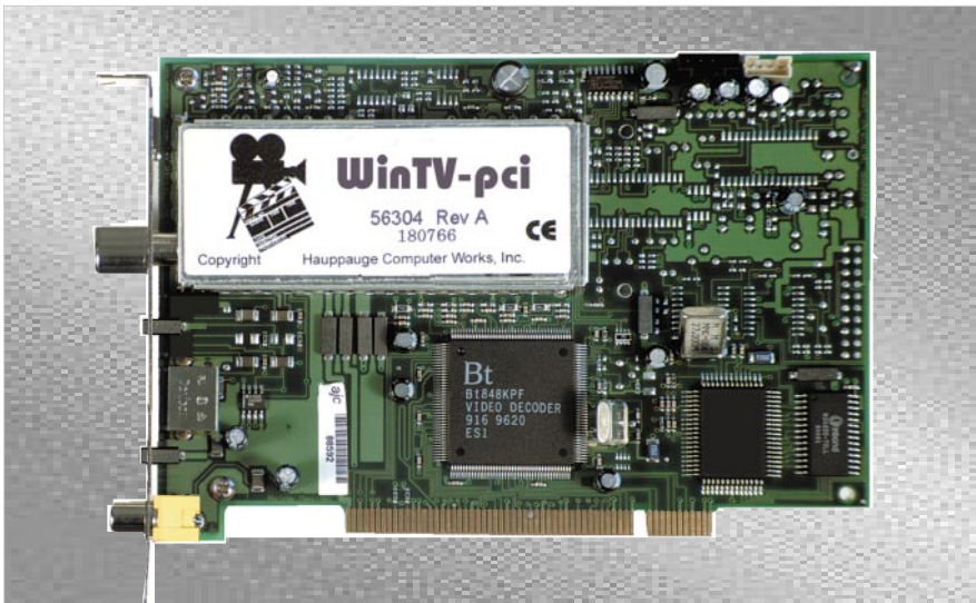
Stereo-Zweikanalton, Videotext und Intericast-Empfang: Die TV-Karte Win/TV PCI von Hauppauge bietet mehr als der gute alte Fernseher (Punkt 5)
