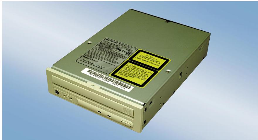
Mitsumi CR-2600TE: Er war der erste Atapi-Brenner und ist eine echte Alternative zu SCSI. Packet Writing und UDF-Treiber funktionieren problemlos
