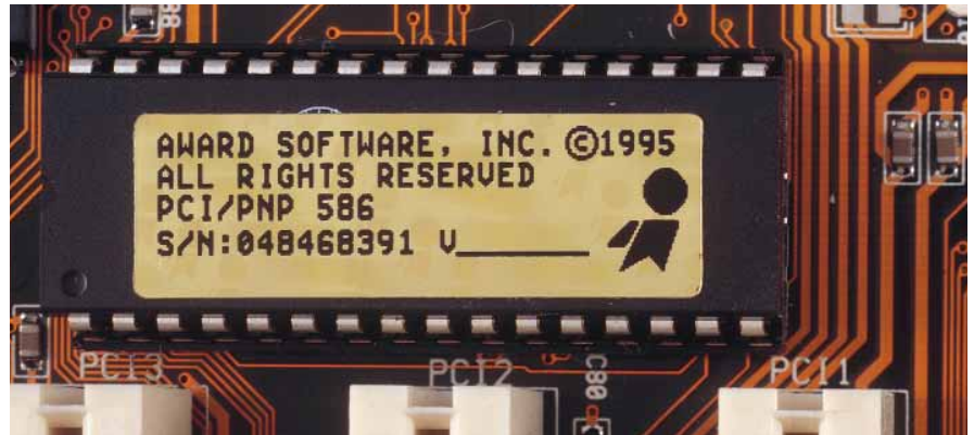
Der Bios-Baustein: Er enthält alle Daten, die Ihr PC zum Hochfahren braucht, sowie die Grundeinstellungen für Gerätekomponenten wie Sound- und Grafikkarte
