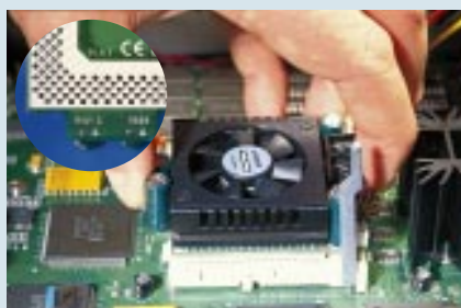
Orientierungspunkt: Halten Sie sie am Pin 1 der CPU
