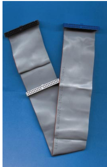
Ultra-DMA/66-Platte: Flott nur mit speziell abgeschirmten Kabeln
