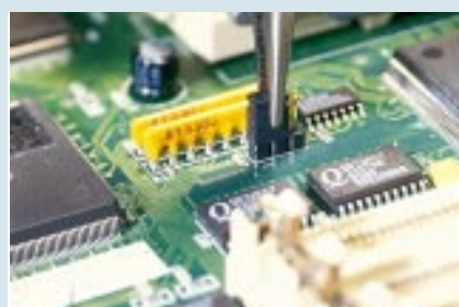
Die Steckbrücken sind wichtig: Konfigurieren Sie diese für die neue CPU
