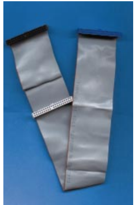
Ultra-DMA/66-Platte: Flott nur mit speziell abgeschirmten Kabeln
