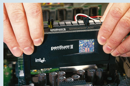
Mit montiertem Kühlkörper: Schieben Sie die neue CPU gerade in den Slot 1
