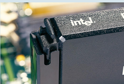
Lösen Sie die Verriegelung: Nun können Sie die CPU aus dem Slot nehmen
