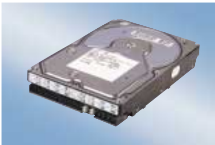
Schnell und groß: Die DTTA 371440 von IBM setzt mit 14,4 GB neue Maßstäbe
