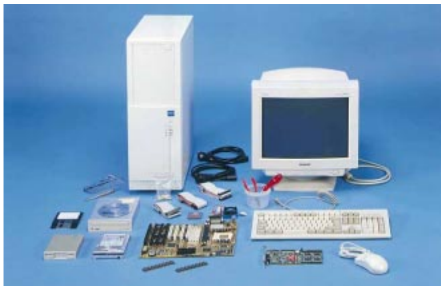
Die Komponenten auf einen Blick: Aus all diesen Einzelteilen bauen Sie sich im Handumdrehen Ihren Rechner. Wir zeigen Ihnen Schritt für Schritt, wie's geht
