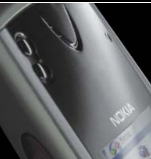
Dvě kolečka v levém rohu mobilu jsou čidla, která po přiložení k uchu ztlumí hlasité handsfree
