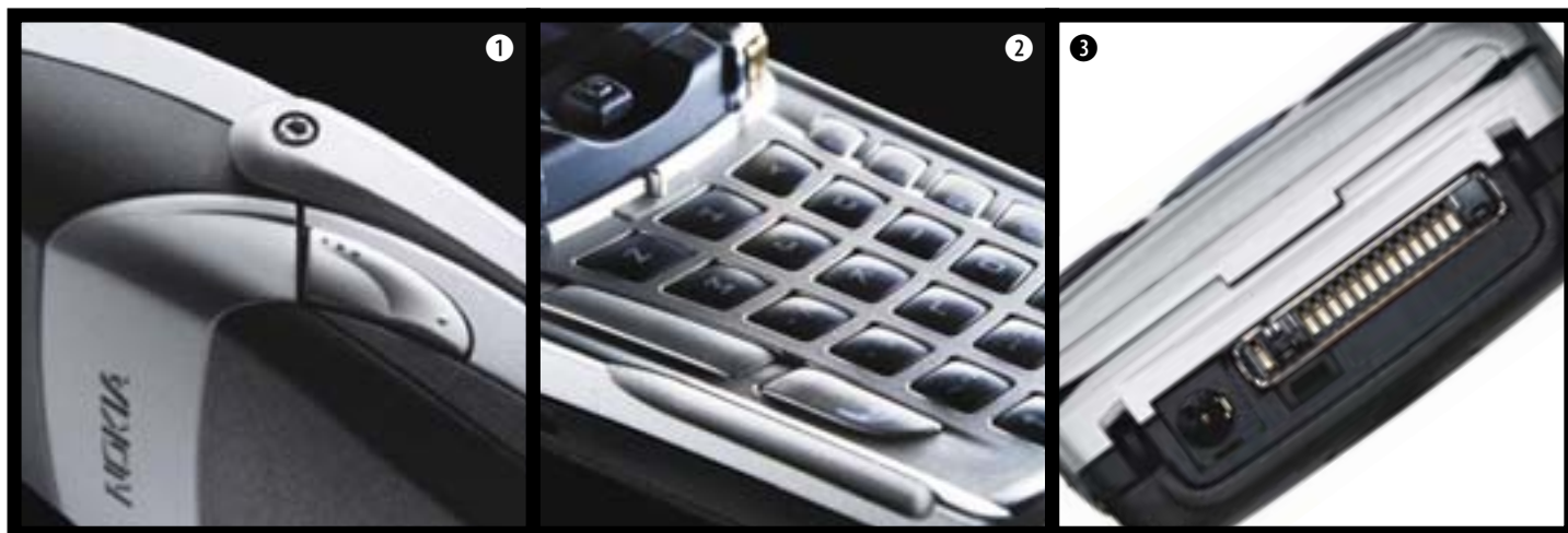
1 odpružení osičky pomáhá při manipulaci s klávesnicí; tlačítko pro ovládání hlasitosti 2 na velké klávesnici se velmi dobře píše; na obrázku je také dobře vidět zlatý kontakt, který v zavřeném stavu spojuje klávesnici s telefonem 3 konektor Pop-Port: jiný tvar, jiné příslušenství
