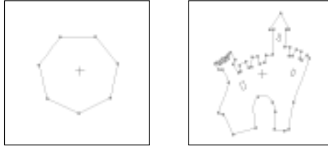
Eine einfache Form mit wenigen Knoten (links) und eine komplexe Form mit vielen Knoten (rechts)
