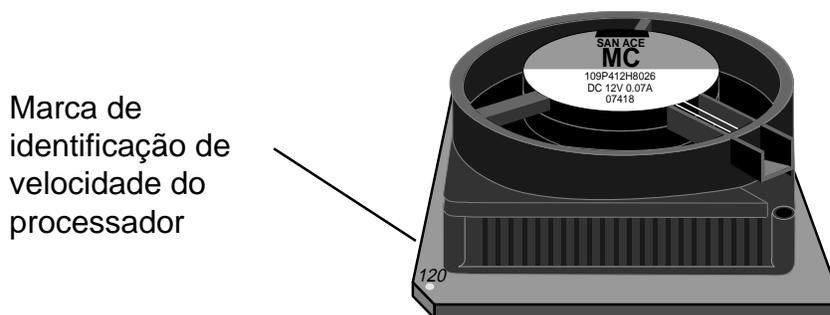
Em todos os processadores Pentium, uma marca adicional na parte de baixo indica se o processador é de 75 MHz ou de maior velocidade, conforme mostrado. Se a velocidade do processador for de 75 MHz, a marca "i75" aparece. Se a velocidade do processador for de 90, 100, 120 e 133 MHz, a marca "iPP" aparece.
