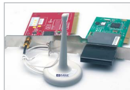
Karta z zewnętrzną anteną, którą MOŻNA ODDALIĆ OD KOMPUTERA , zapewnia większy zasięg – pracę urządzenia mogą zakłócać komponenty komputera.
