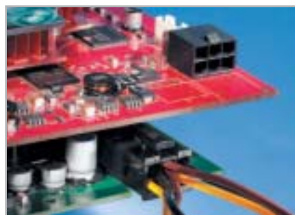
Spezial-Stecker: Die neue 6-polige Stromzufuhr für schnelle PCIe-x16-Grafikkarten.
