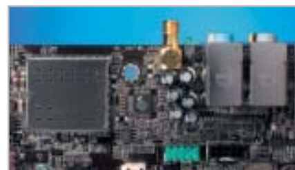
W-LAN onboard: Nur Asus bietet bislang einen Access Point (hinter der Blende links).
