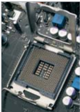
Der neue Sockel-775: Empfindliche Federbeinchen im Sockel sorgen für den Kontakt zur CPU. Im CHIP-Testcenter gab es jedoch keine Probleme mit dem neuen Formfaktor.
