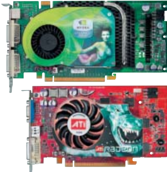
PCIe-x16-Größenvergleich: ATIs X800XT-Referenzkarte ist kleiner als Nvidias GeForce 6800 GT – aber schneller.
