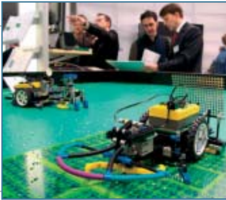
Crash-sicher: Ein System des Fraunhofer Instituts für Experimentelles Software Engineering setzt Programme aus bewährten Teilen neu zusammen. Demonstriert wird das Baukastensystem am Lego-Roboter.
