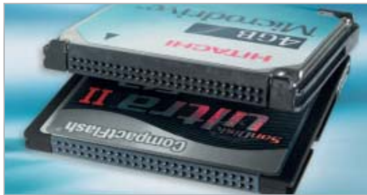
CompactFlash I und II: CF-II-Medien (oben) sind bis zu zwei Millimeter dicker als CF-I-Karten und passen nicht in jeden CF-Slot.
