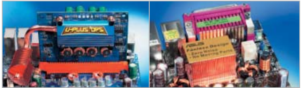
Noch mehr Kühlung: Wegen der hohen Leistungsaufnahme der neuen Pentium 4 (bis 120 Watt) müssen auch die CPU-Spannungswandler aufwendig gekühlt werden – hier Gigabyte 8ANXP-D und Asus P5AD2.
