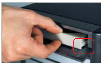
Bremsklotz: Ohne Nachhelfen überwindet die CD-Lade das Soltek-Hindernis nicht.
