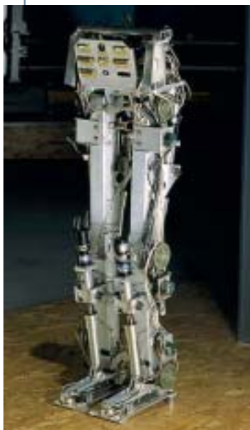
Laufwerk: Hondas E0 aus dem Jahr 1986 war der erste Roboter, der auf zwei Beinen ging. Nach und nach wurde er verbessert.
