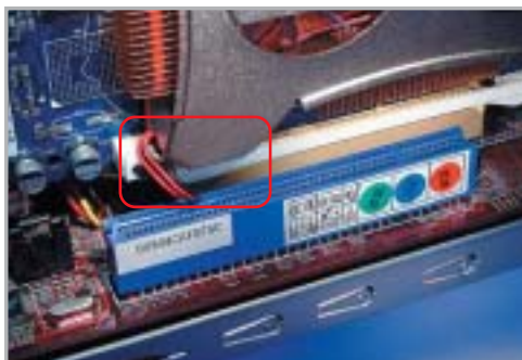
Im Schatten der AGP-Karte: Beim Biostar ragt das Kühlblech der Grafikkarte über den PCI-Slot. Folglich passt keine Karte mehr in den Schlitz.
