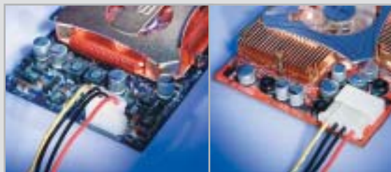
Lieber von hinten: Liegt bei Highend-Grafikkarten der Stromanschluss im rechten Winkel zur Platine (Bild links), widersetzt er sich gerne der Aufmontage der Gehäusewand.
