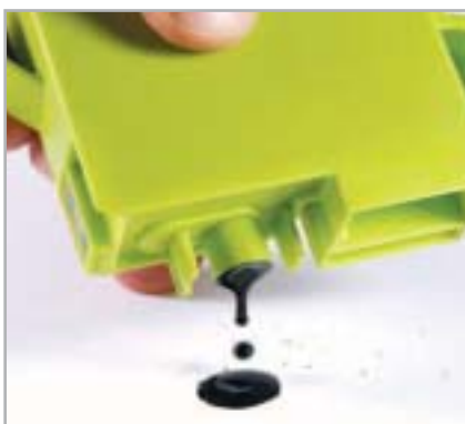
Mangelhaft: Ein leichter Druck auf die Seitenwände der Geha-Patronen (für Epson C82) – und schon schwappt die Tinte raus.
