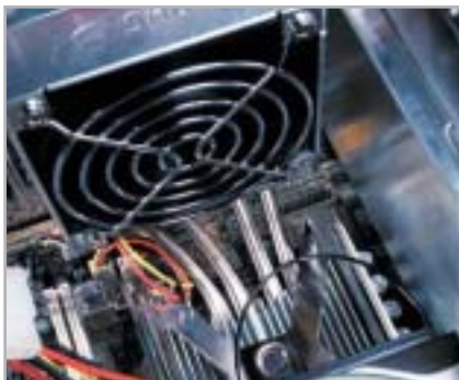
Klima-Anlage: Shuttle erfrischt CPUs seit jeher via Heatpipe. Biostar, ECS und Abit klonen es nach – mit ungleichem Erfolg.
