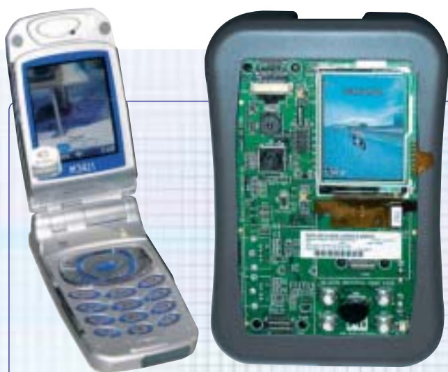
3D-Handys: Nvidias Handy-Grafikchip GoForce 2100 verleiht dem Handy Mitsubishi M341i schon jetzt Spiele-Power, während ATIs Imageon 2300 seine 3D-Fähigkeiten noch auf einem Entwicklungssystem (rechts) demonstrierte.
