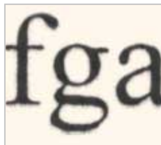
HP: Unter der Lupe zeigt sich, dass der Laserjet die Buchstaben nicht ganz sauber aufträgt.
