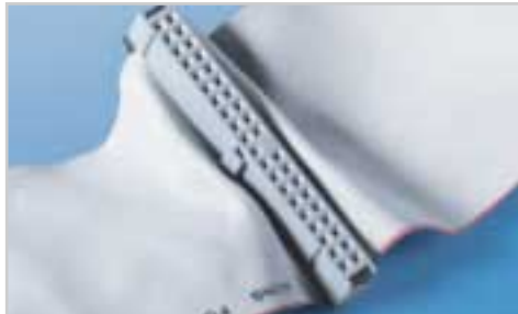
Fehlende Sorgfalt: Wird ein IDE-Kabel derart geknickt, kann leicht eine Leitung brechen.
