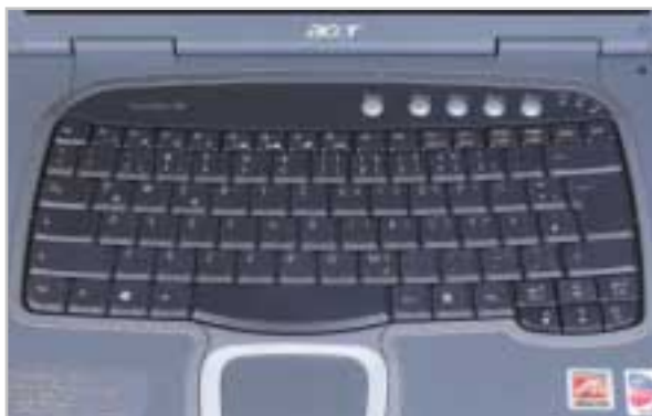
Acer 804LCi: Die Tastatur des 804LCi entlastet die Handgelenke durch ergonomische Ausrichtung der Tasten.
