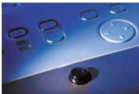
Philips bSure XG2: Beim Philips sitzt der IR-Sensor oben, da trifft die Fernbedienung immer.
