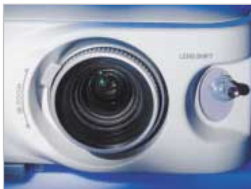
Sharp PG B10S: Nur beim Sharp lässt sich die Lage des Objektivs mechanisch verstellen.
