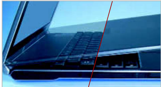
TRICKKISTE: Wird das Sharp Muramasa geschlossen, ziehen sich die Tasten ins Innere zurück. Das spart wertvolle Millimeter.
