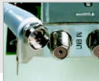
VERBINDUNG: Antenne oder Kabel-TV werden gesteckt (links), Satellitenanschlüsse verschraubt (rechts).
