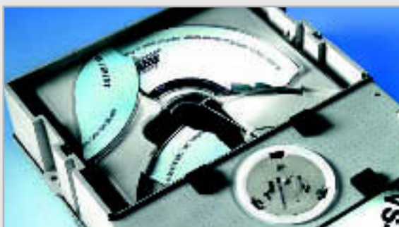
KAPUTT: Eine zu stramme Haltevorrichtung in CD- und DVD-Hüllen verursacht Risse um das Zentrierloch. Bei hoher Drehzahl kann die Scheibe im Laufwerk zerplatzen.
