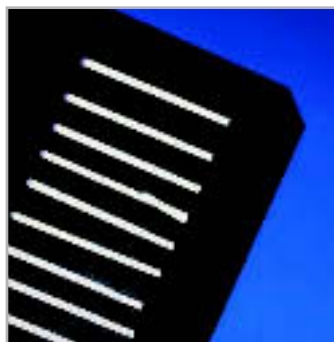
BARREN: Die Wafer werden zunächst in Barren zerbrochen, auf denen die Dioden in einer Reihe sitzen.
