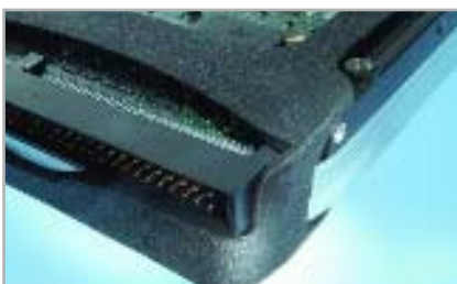
SEAGATE: Dank Gummiüberzug ist die Platte weitgehend unempfindlich gegen kleine Stöße und Metallkontakt.
