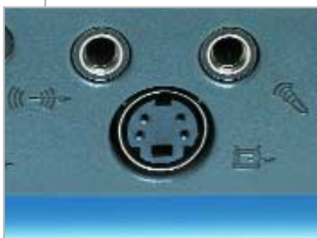
ANSCHLUSSFREUDIG: Kopfhörerausgang, TV-Out (m) und Mikrofoneingang (r).
