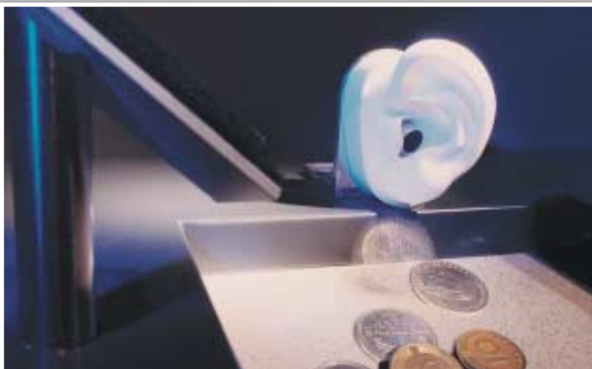
HÖREN: Fällt von der Rampe eine Münze auf die Keramikfliese, nimmt das künstliche Ohr die Schwingungen auf und erkennt an diesen, um welches Geldstück es sich handelt. Ein Mensch müsste lange dafür üben.
