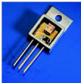
GEHÄUSE: Die Chips sind mit Kontakten versehen, das Metall führt die entstehende Wärme ab.
