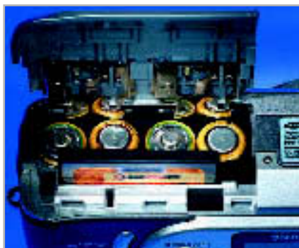
SAMSUNG DIGIMAX 350 SE: Weil die vier Akkus nicht arretiert sind, fallen sie beim Wechseln der Speicherkarte oft heraus.
