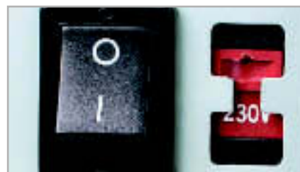
STROMFRESSER: Bei importierten Geräten müssen Sie vor dem Einschalten den PC von »120« auf »230« Volt umschalten.
