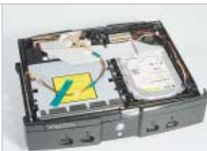
5 RUHEPLATZ: Hinter dem DVD-Laufwerk ist Raum für das EPROM.
