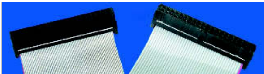
80- ODER 40-POLIGES FLACHKABEL: Für DVD-Laufwerke reicht das Standard-IDE-Kabel (rechts) völlig aus. Es ist billiger als das Ultra-DMD66/100-Kabel (links).
