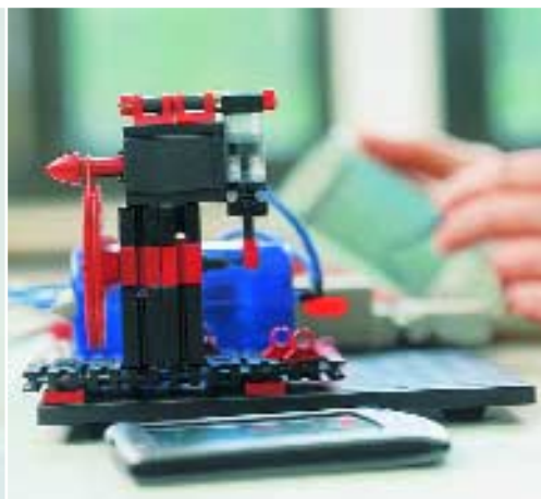
NEUZUGANG PDAs: Die Geräte des neuen Testfeldes positioniert Redakteur Benno Hessler so unter dem Testroboter, dass dieser vollautomatisch mit seinem Stempel die Akku-Laufzeit im Dauerbetrieb messen kann.
