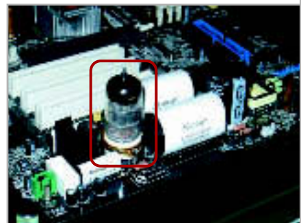
RÖHRE HÖREN: Aopen-Board mit Röhrenvorverstärker für den puren Analog-Klang.
