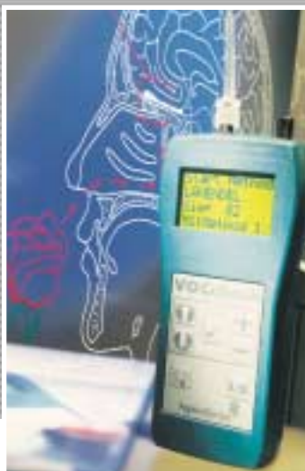
RIECHEN: Vier Geruchs-Sensoren reichen der künstlichen Nase aus, um Düfte wiederzuerkennen.
