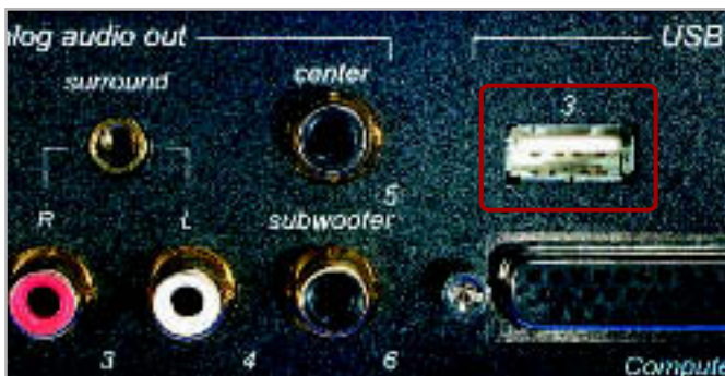
USB-VERBINDUNG: Die Hercules Game Theater XP bietet auf der Anschlussbox unter anderem einen USB-Passiv-Hub.
