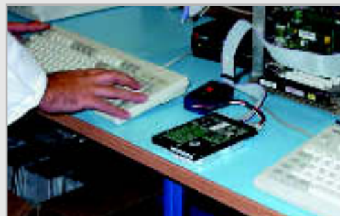
BÖBLINGER LÖSCHKONTROLLE: Der Ingenieur von Ontrack erzeugt ein Image von der gelöschten Festplatte.
