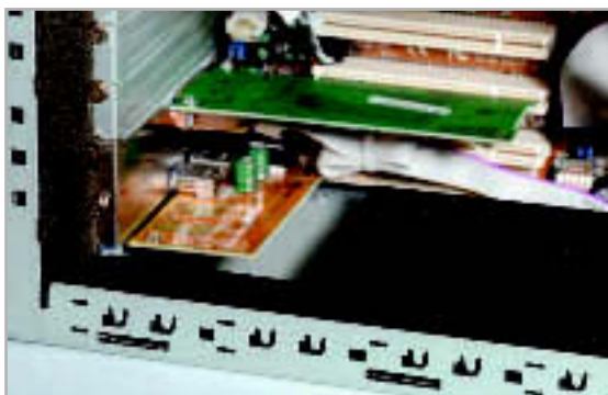
GUMMIZELLE: Terra bannt beim Orbis mittels Schaumgummi-Dämmung den Lärm im Gehäuse. Nur der Vobis-Rechner ist noch leiser – und das ohne Dämmung.
