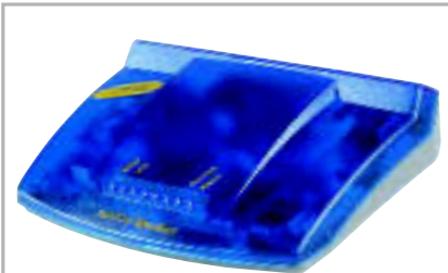
DER ROUTER – HARDWARE-ICS-LÖSUNG: Er erledigt die gleichen Aufgaben wie der Server-PC bei der ICS-Lösung.
