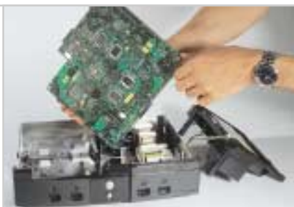
2 KNACKPUNKT: Vorsichtig anheben – Kondensatoren brechen leicht ab.
