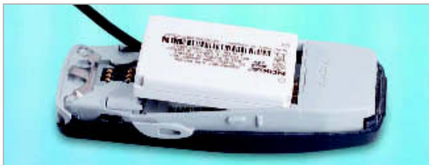
DATENKABEL UNTERM VERDECK: Jede Handy-Reihe bei Nokia verlangt ein eigenes Datenkabel und Einsteck-System. Beim Nokia 33xx verschwindet der Stecker unter dem Akku.
