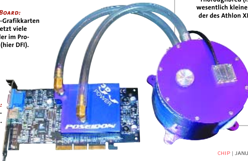
OVERCLOCKERS DREAM: Flüssigkühlung für 3D-Grafikkarten.
