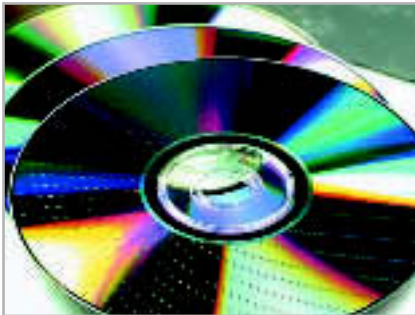
DVD-RAM-ROHLING: Mit dem bloßen Auge können Sie die Sektormarken deutlich erkennen. Sie beschleunigen den Zugriff.
