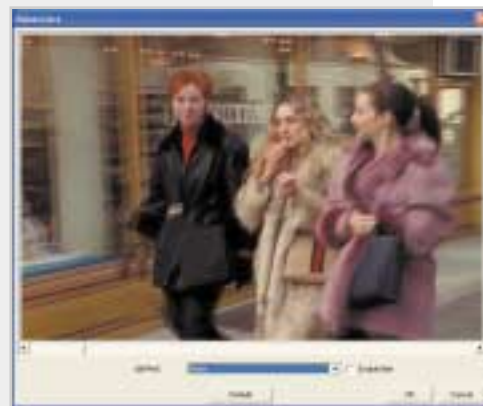
NTSC-CHAOS: Ein Vollbild entsteht aus zwei Halbbildern – aber nicht aus der gleichen Szene.
