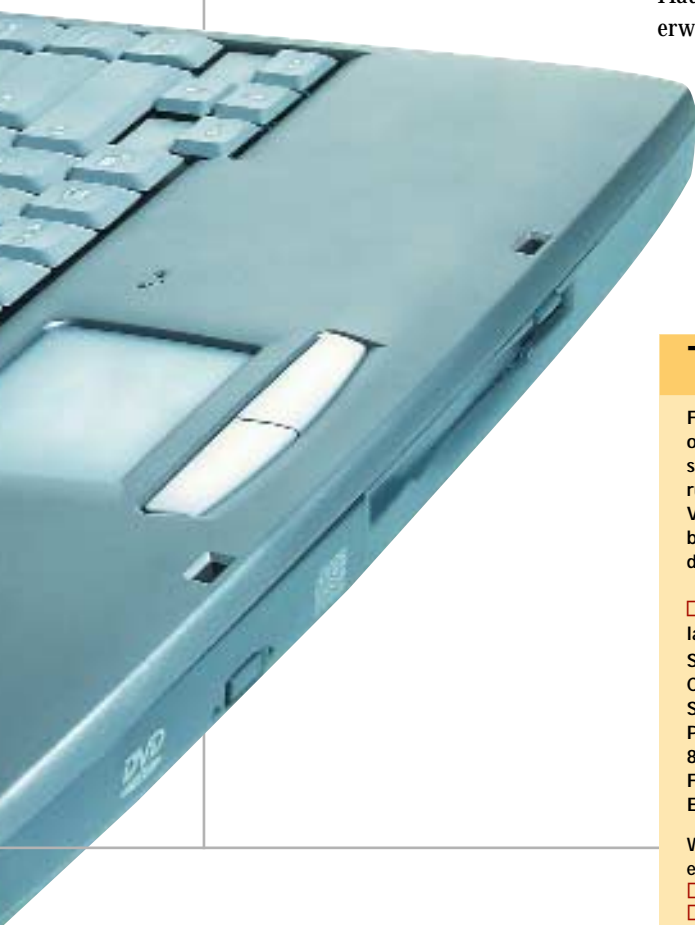
ANSCHLUSSFREUDIG: Kopfhörerausgang, TV-Out (m) und Mikrofoneingang (r).
