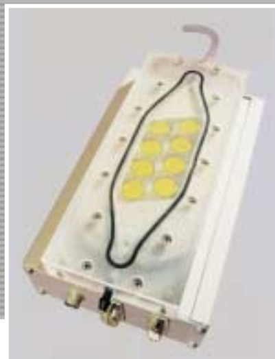
SCHMECKEN: Die acht Sensoren der Kunstzunge sind dem Verwendungszweck entsprechend beschichtet und reagieren nur auf die gesuchten Stoffe.
