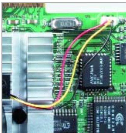
SELTENER ANBLICK: Die Leadtek GeForce 3 verfügt über einen geregelten Lüfter (drei Kabel), der die Temperatur konstant hält.
