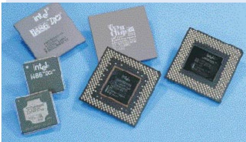
Gesockelte Prozessoren: Von links nach rechts sind 486er von Intel und AMD, ein IDT Winchip mit 200 MHz, ein Intel Pentium 200 MMX und ein Celeron mit 500 MHz zu sehen.
