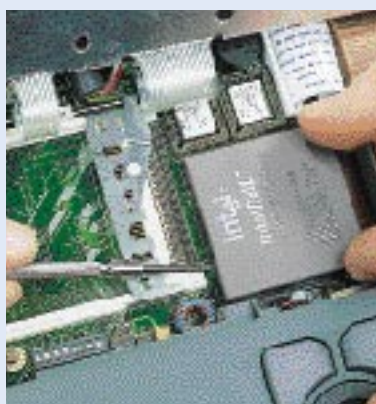
Prozessorwechsel möglich: Sockel und DIP-Schalter sind vorhanden.
