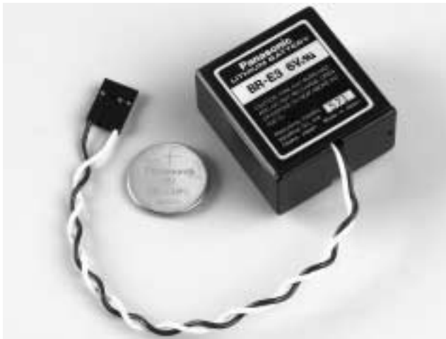
Bild 2.8: Batterien für das CMOS-RAM gibt es in den unterschiedlichsten Ausführungen
