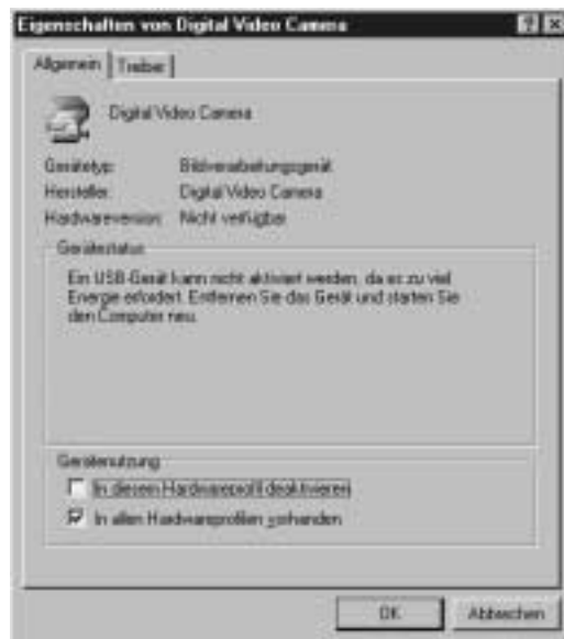
Bild 9.27: Der verwendete USB-Anschluss kann die PC-Kamera nicht mit ausreichend Strom beliefern
