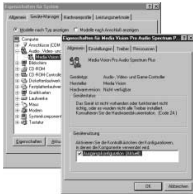
Bild 8.1: GERÄTE-MANAGER mit dem EIGENSCHAFTEN-Dialog einer fehlerhaft installierten Soundkarte
