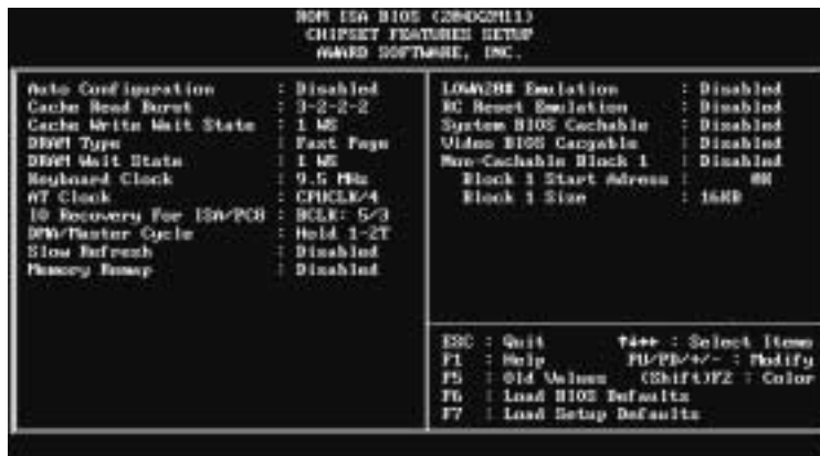
Bild 2.6: Das BIOS-Setup enthält Daten für die Konfiguration des Chipsatzes
