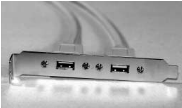
Bild 17.2: USB-Slotblech für AT-Systemboard
