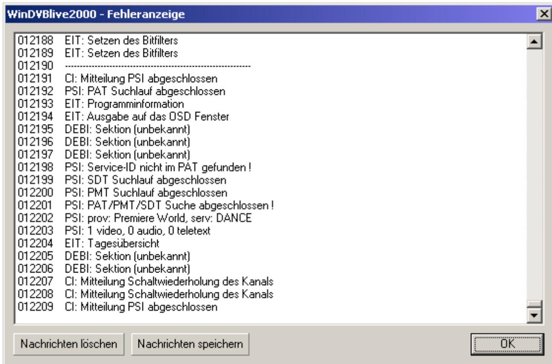
In diesem Fenster werden alle Vorgänge während des Betriebes der Karte aufgezeichnet. Es dient zur Nachverfolgung, wenn Probleme beim Betrieb der Karte entstehen. Diese Auflistung kann abgespeichert werden und an **ODSoft Multimedia** geschickt werden.
