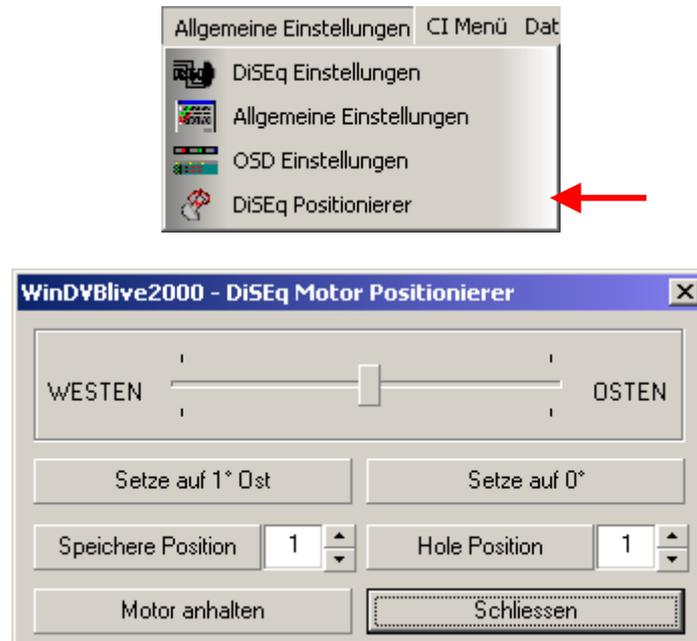
WinDVBlive2000 bietet die Möglichkeit einen Drehmotor anzusteuern. Durch das Verschieben des Reglers nach Osten oder Westen besteht die Möglichkeit dann durch drücken der Taste "Setze auf X° West/Ost" einen DiSEq Drehmotor auf diese Position zu bringen.
