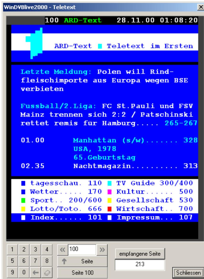
Das Videotextfenster kann entweder über das Icon in der Symbolleiste oder über das Menü aufgerufen werden. Voraussetzung für die korrekte Darstellung des Videotextes ist eine eingetragene „Teletext-PID“ (nicht 8191 !) für den entsprechenden Sender in der Kanalliste.
