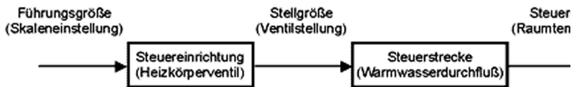
Blockschaltbild einer Steuerung (Wärmezufuhr an einem Heizkörper)
