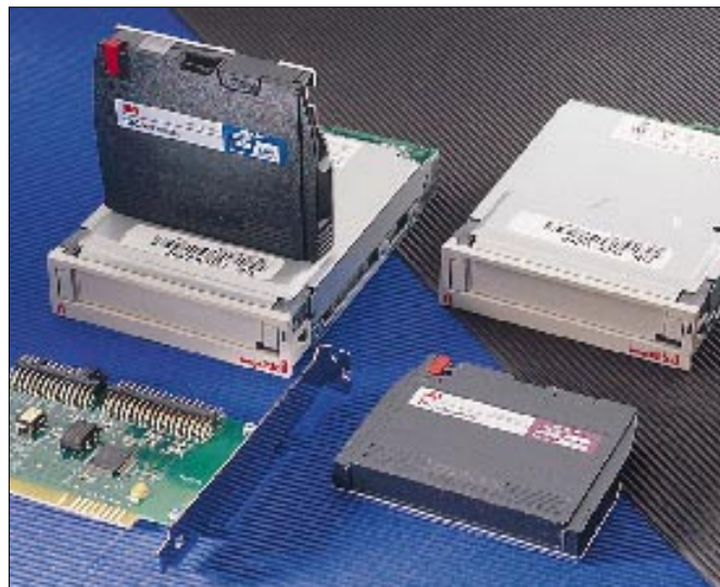
Neue Zauberformel: Floppy-Streamer für Travan-Cartridges lösen die QIC-Laufwerke ab
