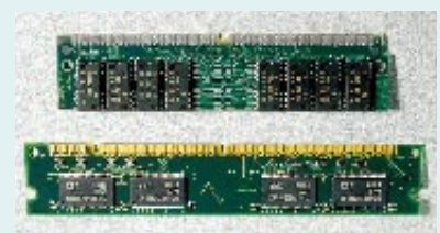
Vergleich: Oben die 72poligen PS/2-SIMMs, unten die 168poligen DIMMs
