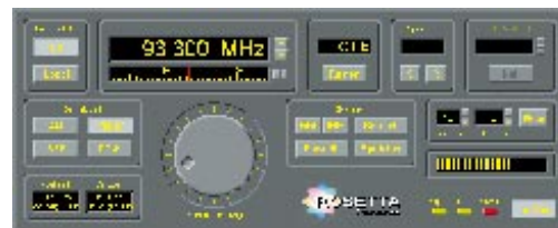
Das Ohr zur Welt: Die Winradio-Steckkarte von Rosetta macht aus dem PC einen professionellen Funkscanner mit breitem Empfangsbereich
