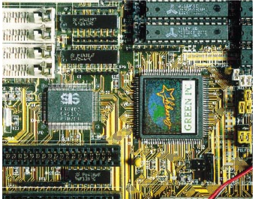
Zwei Übeltäter: Beide Schaltkreise der SiS-Chips auf der Hauptplatine waren defekt; sie blockierten die Diskettenzugriffe, indem sie den DMA-Transfer beeinträchtigten
