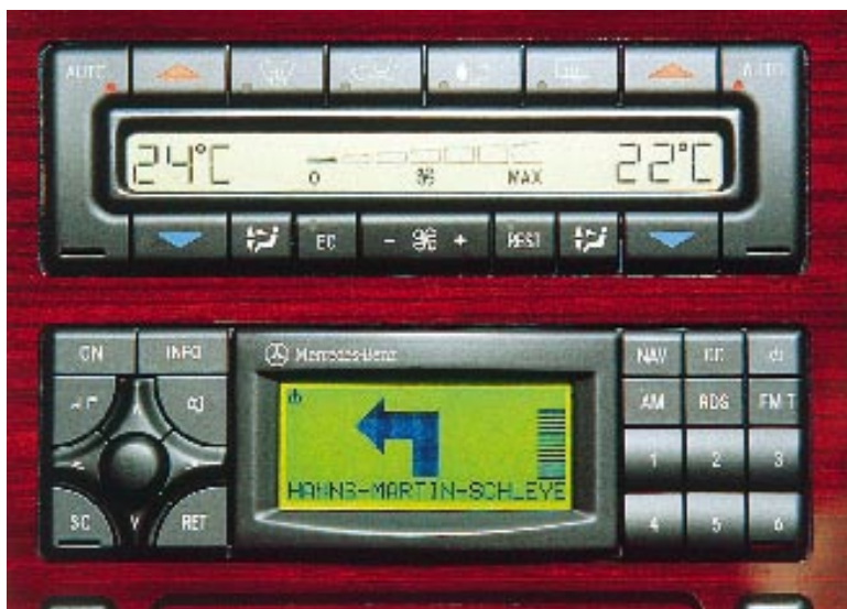
Radio mit Autopilot: Das im Mercedes eingebaute APS-System von Blaupunkt ist im Wageninneren auf den ersten Blick kaum wahrzunehmen
