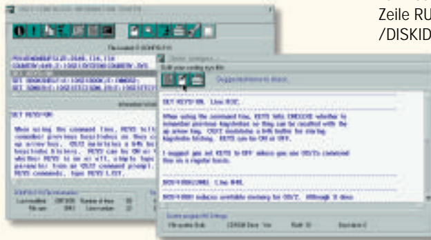
Das CONFIG.SYS Information Center erlaubt in einfacher Weise, die Einstellungen und Befehle der Warp-Systemdatei zu ändern. Der Anwender bekommt Hinweise zu den verschiedenen Kommandos, etwa wie diese einzusetzen sind und was man ändern kann
