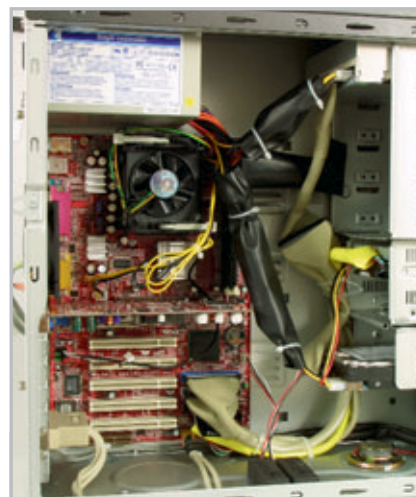
UltraMedia Black Angel: w środku panuje WZOROWY PORZĄDEK . Ma to znaczenie nie tylko estetyczne – poprawia skuteczność chłodzenia podzespołów.
