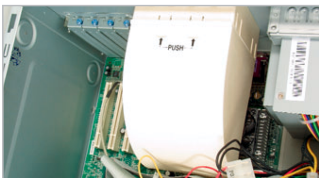
Do niedawna ten SPOSÓB CHŁODZENIA zarezerwowany był wyłącznie dla serwerów i drogich, markowych, konstrukcji. Teraz osłony kierujące strumień powietrza na procesor można spotkać w tańszych, popularnych maszynach.
