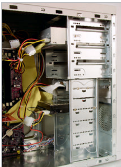
Dobrze umocowana i pojemna SZYNA MONTAŻOWA zapewnia takie warunki montażu „twardzieli”, by nie było problemu z ich chłodzeniem
