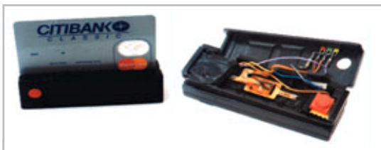
URZĄDZENIE KOPIUJĄCE pasek magnetyczny karty bez trudu mieści się w dłoni i nie jest skomplikowane.
