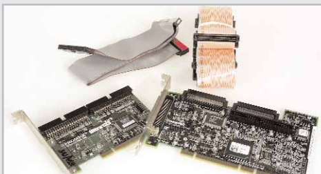
Bez kontrolera ani rusz. KARTY ADAPTEC 29160 i PROMISE ULTRA133TX umożliwiły przetestowanie dysków w tych samych warunkach.
