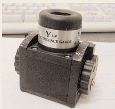
Przyrząd do pomiarów zbieżności składowych barwnych obrazu.
