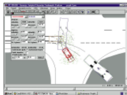
Obraz zarejestrowany okiem kamery przekształcany jest na rzut pionowy z zachowaniem wszystkich odległości
