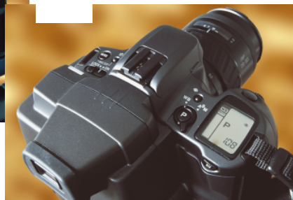
Dobudowany do Minolty plastikowy wizjer daje bardzo kiepski obraz; duży, czytelny wyświetlacz uzupełnia o wskazania pracy części cyfrowej
