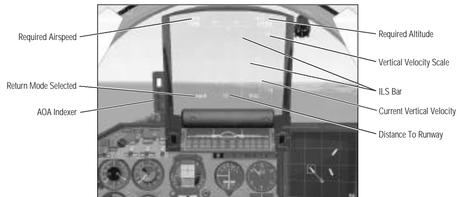
Figure 5-7: HUD symbology in Landing mode with the ALS
