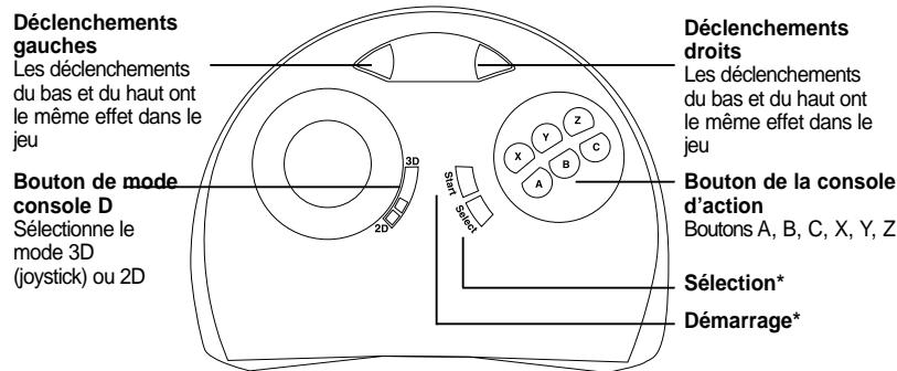
\* La fonction réelle des boutons **Select** et **Start** sous DirectInput dépendent du jeu (ils peuvent être utilisés pour des actions différentes de la sélection et du démarrage dans le jeu).
