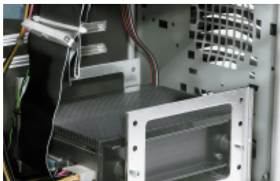
Die von Haus aus leise Seagate-Platte ist in einem vollgepackten und vibrationsgedämmten Spezialgehäuse integriert.
