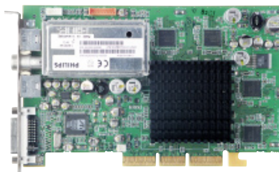
Die Radeon-9000-Grafikkarte wird passiv gekühlt. Für stärkere 3D-Karten führt Deltatronic eine Heatpipe-Kühlung.
