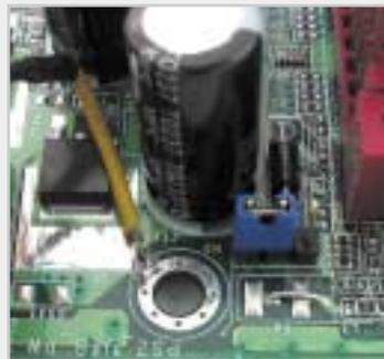
**TITIK GROUND :** Lubang sekrup ini adalah titik ground yang paling aman untuk Anda melakukan penyolderan.
