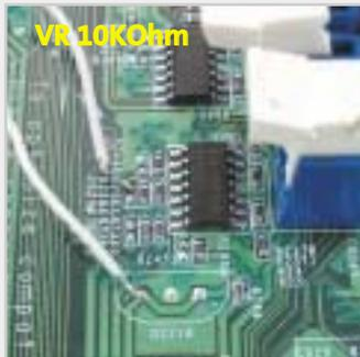
**VDD K758X:** Anda tinggal menyolder Variable Resistor 10 KOhm di dua titik ini di dekat slot memori.
