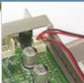
**DUA FAN, SATU KONEKTOR:** Kedua fan pada graphic card ini tampak terhubung ke sebuah konektor.
