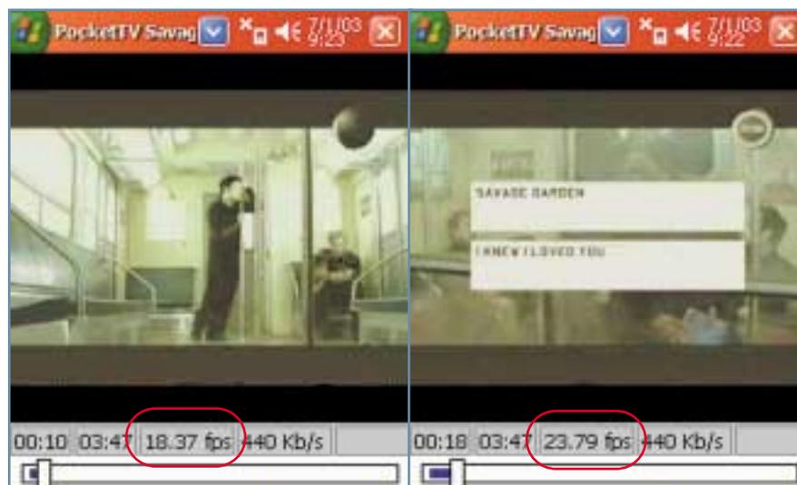
**Signifikan:** Peningkatan kecepatan pemutaran video dari 18.37 fps ke 23.79 rasanya cukup signifikan. Tes dilakukan pada iPAQ 5450 dengan clock standar (400 MHz) dan 472 Mhz.
