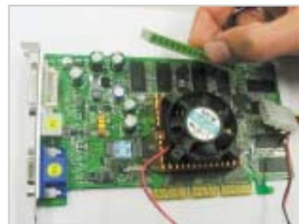
**7a** LANGKAH 1: Tempatkan kipas dan elemen pendingin untuk memori pada graphic-card GeForce FX-5200.
