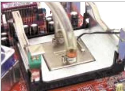
**PENGUNCI WATERBLOC:** Cara menginstall waterblock memang tidak berbeda dengan heatsink biasa.
