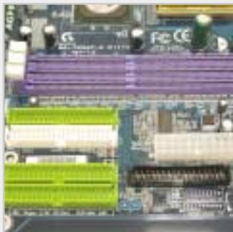
**EMPAT IDE:** RAID IDE sudah kian mudah ditemui pada board untuk sistem AMD. Selain itu, perhatikan posisi konektor PSU. Sudah sangat baik bukan?
