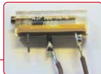
**5a** POTENSIOMETER TRIMMER: Memungkinkan fine-tuning tegangan operasi.
