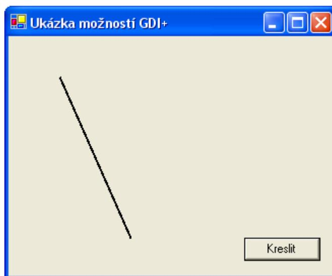
Obr. 1 – Generování úsečky pomocí metody **DrawLine**
