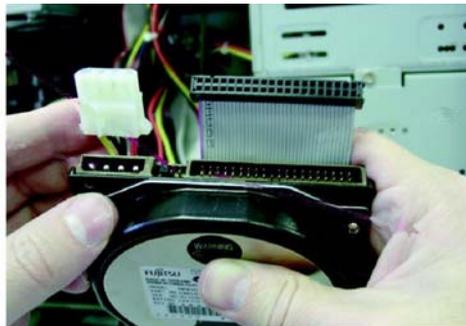
4. 電源ケーブルのコネクタを新しいハードディスクに差し込みます。電源ケーブルは決まった向きでしか接続できないようになっています。無理に挿入しないでください。
