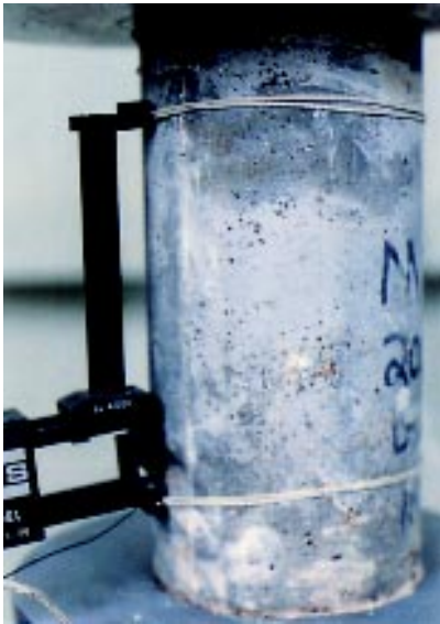
Los cilindros del material de ensayo están sujetos a compresión para determinar el cambio de longitud al fallar.
