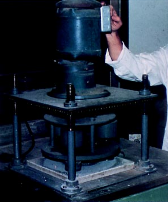
Máquina de Abrasión de Discos Rotatorios (ASTM C 779)
