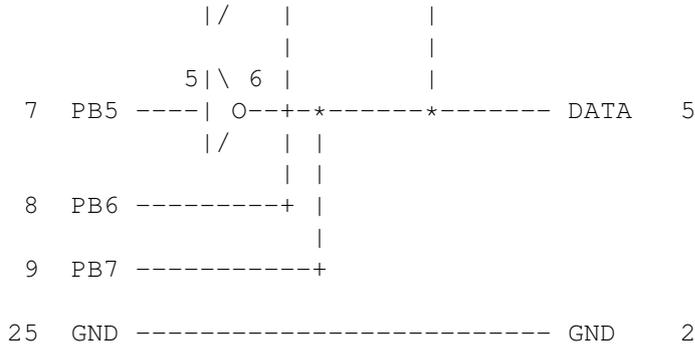
Der 7406 (ein 74LS05 tut's auch) muß natürlich noch mit +5V und GND verbunden werden. Dem Fachmann wird auffallen, daß dies die selbe Schaltung ist, die sich auch im echten C64 befindet.
