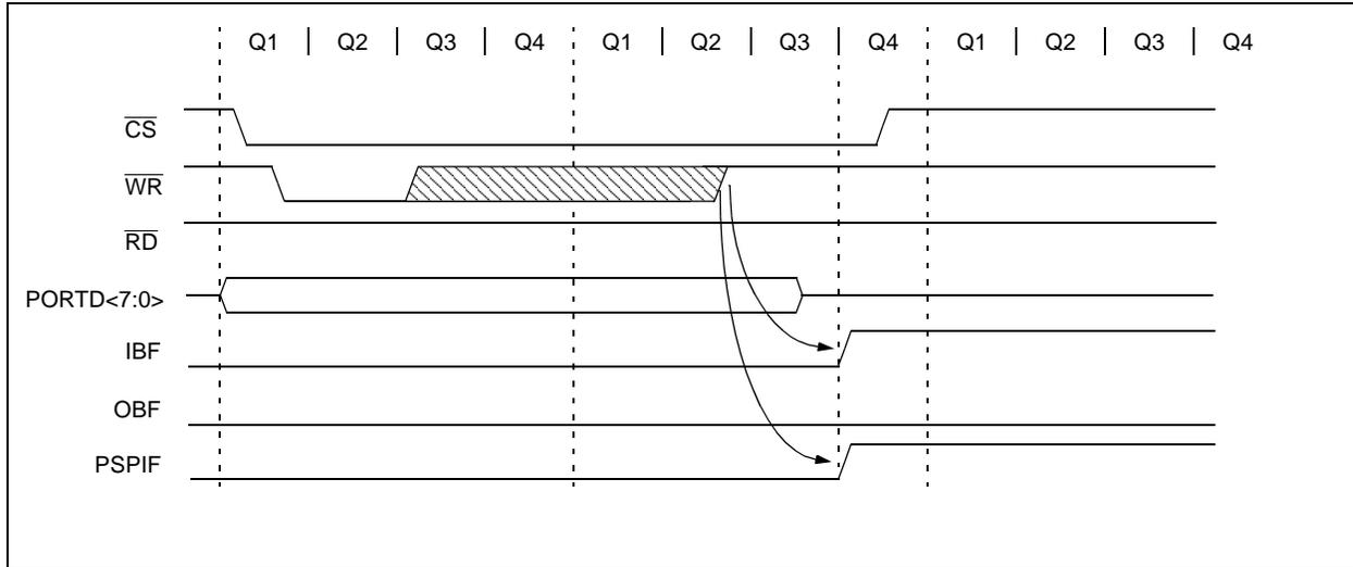
**FIGURE 3-11: PARALLEL SLAVE PORT READ WAVEFORMS**
