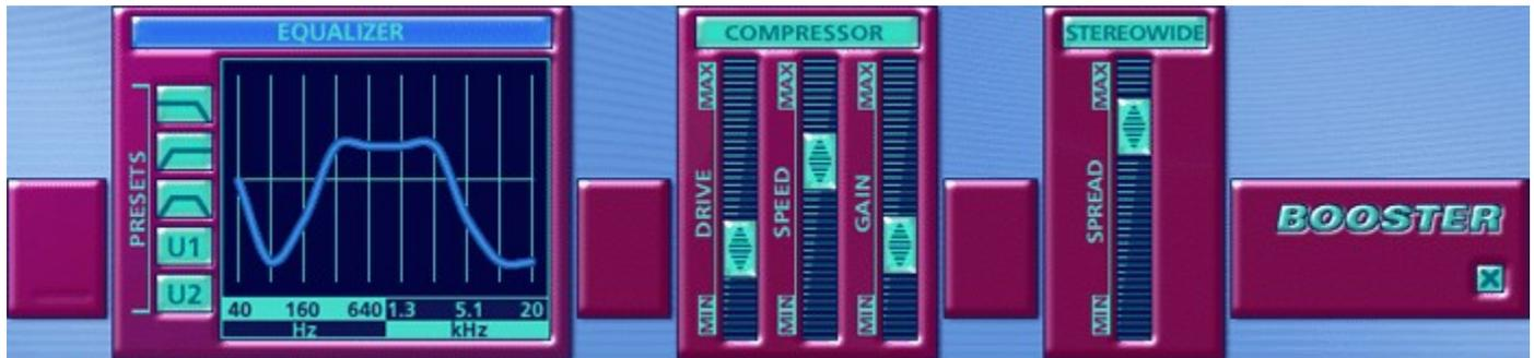
Mit dem Equalizer, der dieselben Einstellungsmöglichkeiten hat wie der EQ im FX Studio, kannst du Unebenheiten im Frequenzgang deines Mixes korrigieren. Du senkst einfach Frequenzen ab, die zu weit im Vordergrund stehen, oder holst Frequenzen hervor, die zu leise sind. Meist sind es schon geringfügige Änderungen, die den Klang verbessern, und zu starke Reglerstellungen klingen häufig nicht sehr gut. Hier brauchst du Fingerspitzengefühl und ein geduldiges Ohr.
