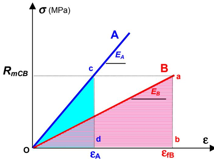
Si l'on schématise les courbes de compression des deux matériaux (voir figure ci-contre), on note que la rupture se produit quand la contrainte atteint la valeur de la résistance en compression  $R_{mCB}$  de la porcelaine (matériau B).
