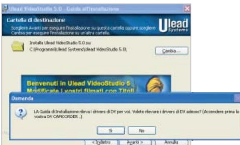
**1** Durante l'installazione, VideoStudio può rilevare automaticamente la presenza di una videocamera DV collegata a una scheda IEEE 1394
