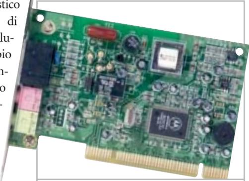
**6** Aggiornando i driver software dei modem che usano i chip Motorola si possono risolvere alcuni problemi di connessione
