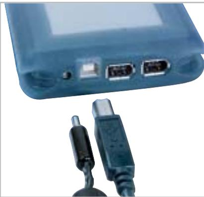
**23** Utilizzando un hard disk Usb conviene servirsì di un alimentatore separato
