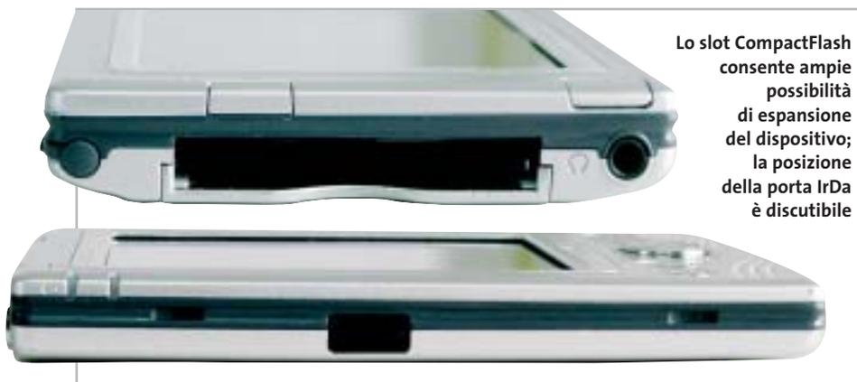
Lo slot CompactFlash consente ampie possibilità di espansione del dispositivo; la posizione della porta IrDa è discutibile
