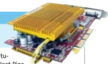
Il kit ZM80A-HP di Zalman fornisce un'efficace dissipazione della Gpu utilizzando il sistema Heat Pipe
