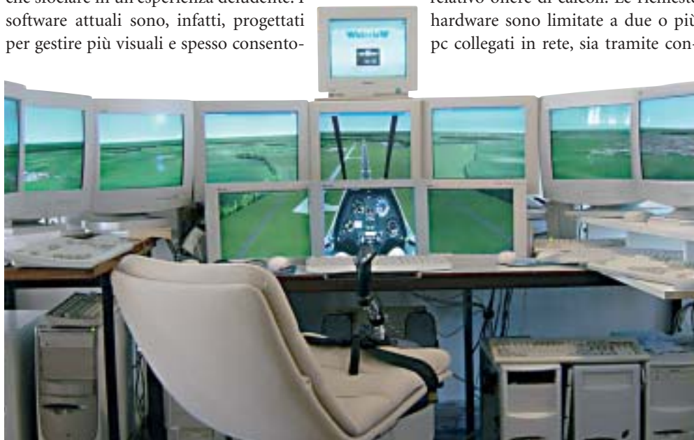
La visione panoramica in un ambiente di simulazione di volo assicura la completa padronanza della situazione
