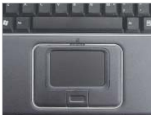
La pulsantiera del touchpad utilizza una soluzione monoblocco per i tasti destro e sinistro
