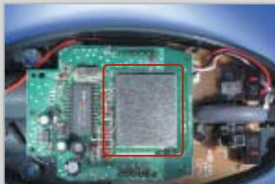
Il modulo trasmettente a 2,4 GHz assicura assenza di interferenze su notevoli distanze
