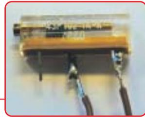
**5a** Trimmer potenziometrico: permette di dosare finemente la tensione di alimentazione
