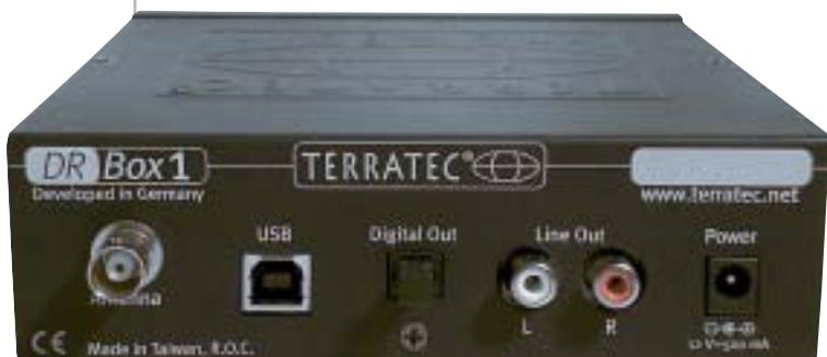
Oltre alla classica uscita stereo Rca è presente un connettore S/Pdif ottico e una porta Usb per l'interfacciamento con il pc
