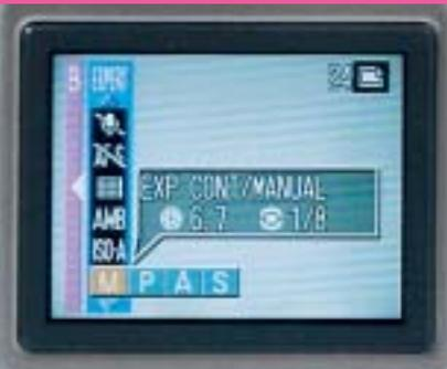
Pur essendo destinate ai fotografi meno esperti, numerose fotocamere digitali compatte offrono comunque un controllo accurato sui parametri di esposizione
