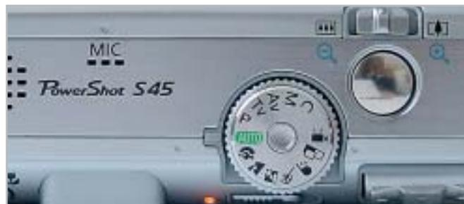
Il selettore rotante della Canon PowerShot S45 consente di scegliere fra una dozzina di modalità di esposizione diverse
