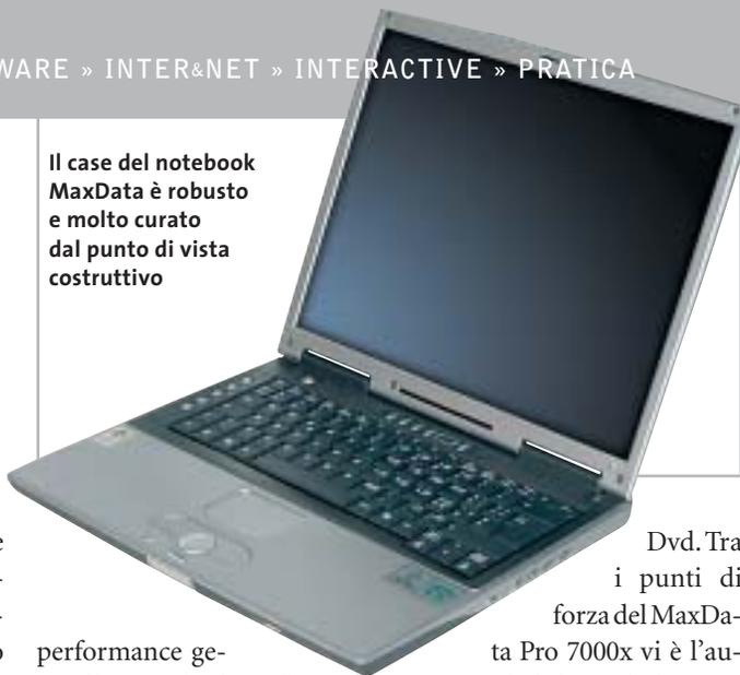
Dvd. Tra i punti di forza del MaxData Pro 7000x vi è l'autonomia: la batteria da 4.400 mAh è in grado di alimentare il notebook per quasi quattro ore, un record per un portatile di queste dimensioni con un solo accumulatore.
