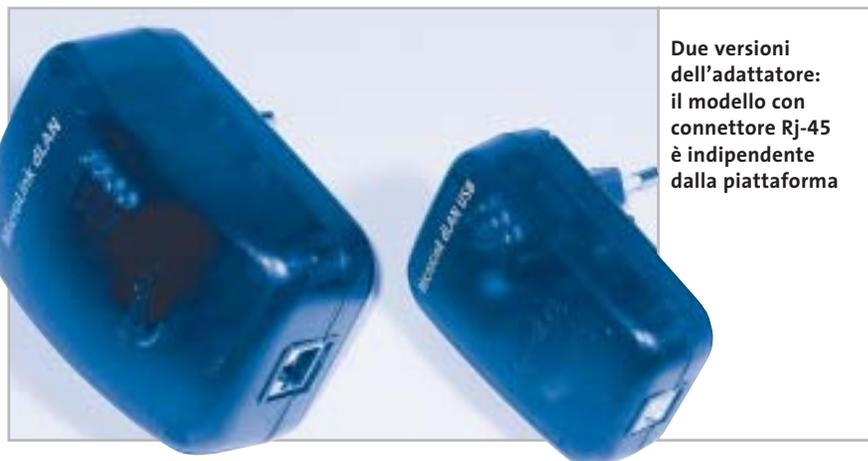
Due versioni dell'adattatore: il modello con connettore Rj-45 è indipendente dalla piattaforma
