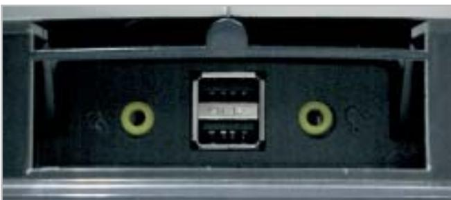
Un pannellino frontale cela due porte Usb e i connettori per microfono e cuffie sul pc di Focelda
