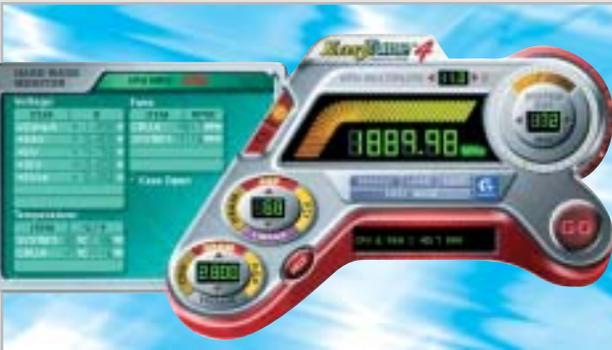
L'utility EasyTune 4 fornita con la motherboard Gigabyte facilita notevolmente la procedura di overclock della Cpu. In tempo reale è possibile monitorare le temperature dei componenti e variare frequenze e tensioni d'alimentazione
