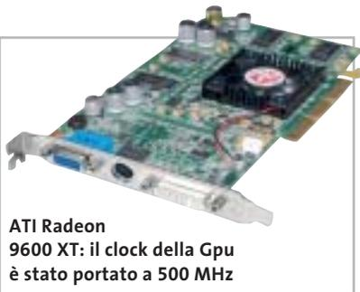
ATI Radeon 9600 XT: il clock della Gpu è stato portato a 500 MHz
