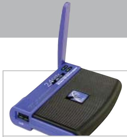
**3.3** Per collegare un pc alla Wlan occorre una ricetrasmittente. Nella foto un modello esterno con interfaccia Usb
