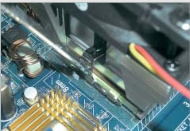
**3** Si può quindi procedere con il montaggio del dissipatore, servendosi di un cacciavite a punta piatta per fissare il sistema d'aggancio
