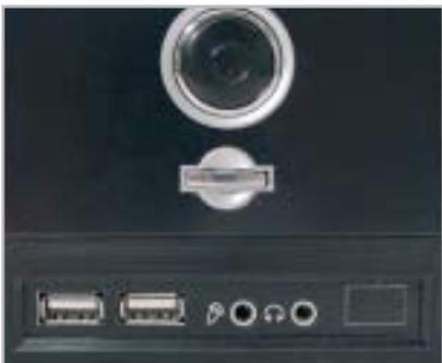
Anche sul pc di Mitas sono riportate sul fronte due porte Usb 2.0 e i connettori mini-jack per cuffie e microfono
