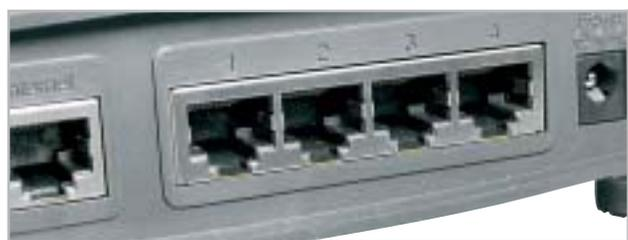
Quattro porte Ethernet consentono il collegamento via cavo di altrettanti pc
