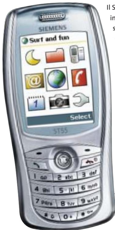
Il Siemens ST55 è un cellulare con fotocamera integrata, dotata di zoom 4x capace di scattare foto a una risoluzione massima di 640 x 480 pixel. Le immagini possono essere inviate via Mms oppure memorizzate nell'album del telefonino, che ha una capacità di 1,2 Mb.
