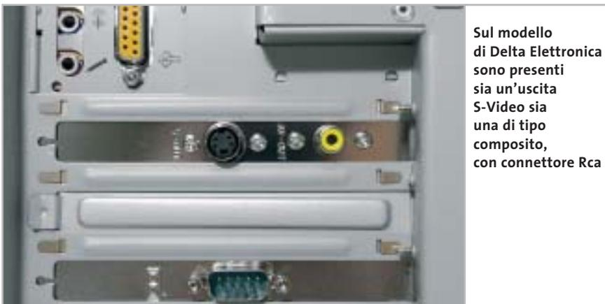
**Sul modello di Delta Elettronica sono presenti sia un'uscita S-Video sia una di tipo composito, con connettore Rca**
