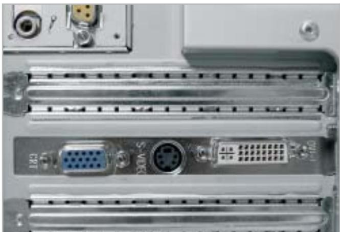
La scheda video impiegata sul pc di Eniak mette a disposizione un'uscita digitale Dvi per il collegamento a pannelli Lcd
