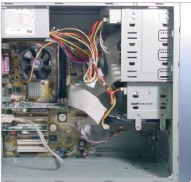
**Le piattine Ide sul pc MediaInformatica non sono state ripiegate e fissate: lasciate libere possono intralciare la circolazione interna dell'aria**
