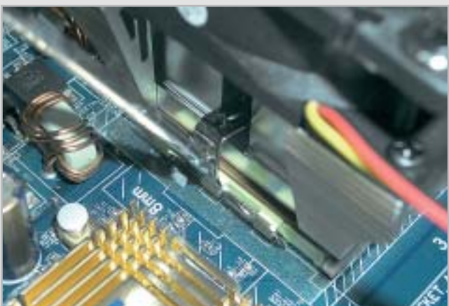
3 Si può quindi procedere con il montaggio del dissipatore, servendosi di un cacciavite a punta piatta per fissare il sistema d'aggancio
