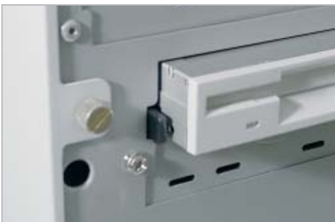
Apertura facilitata: il case di Si Computer è di tipo "screwless", con viti di apertura ad azionamento manuale
