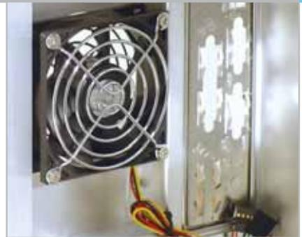
**Ventola posteriore per la dissipazione di calore sul Cooler Master ATC-210**
