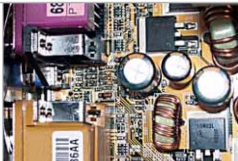
e/o resistenza 151 e l'altra alla massa del circuito. Per eliminare il filtro gli induttori vanno cortocircuitati o rimpiazzati da ponticelli di rame o stagno. Naturalmente l'operazione annulla la garanzia della scheda, e in caso di errori può causare danni.
