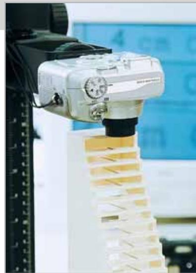
La scala per le macro di CHIP: con questo apparecchio di misura della CNC abbiamo valutato le capacità di riprese macro delle fotocamere
