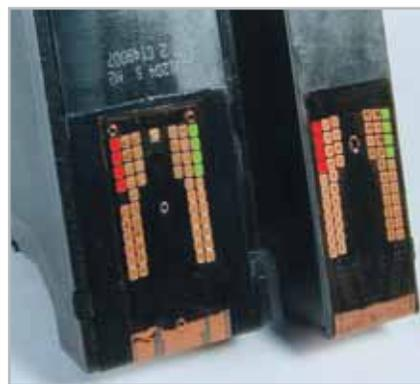
**12** Raggirate con un nastro adesivo: una volta coprire con il nastro l'area contatti rossa, una volta quella in verde, e poi rimontare senza nastro
