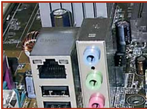
La scheda madre Asus A7V8X monta di serie un controller Gigabit Ethernet basato sul chip Broadcom 5702
