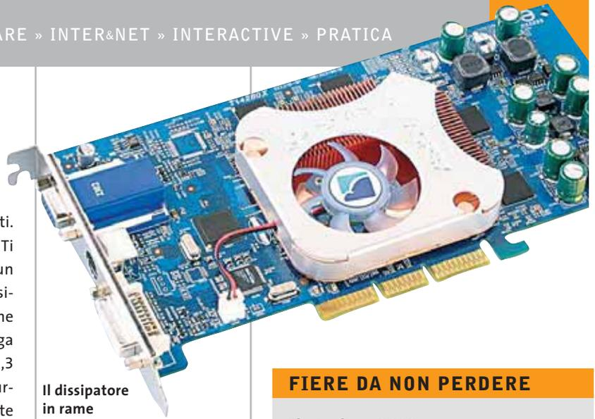
Il dissipatore in rame è indispensabile per raffreddare adeguatamente la Gpu Turbo
